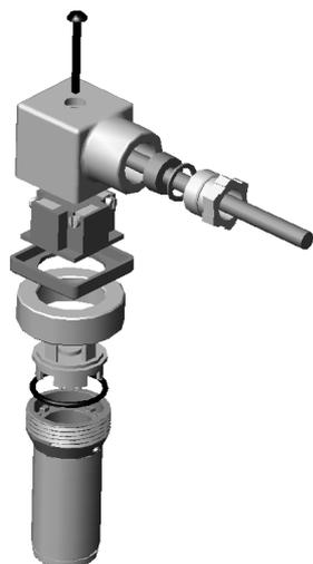
**Figura 1 - Explosão do conector**
